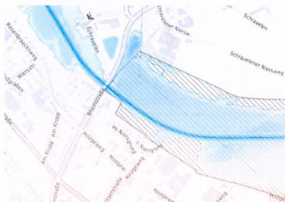
Abb. 1: Hochwasserbereich (Grundlage: 1000-jähriges Ereignis (HQ extrem))
