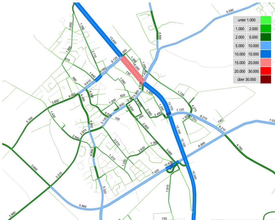
Abb. 2.3.1.3-11 Verkehrsmodell Nullprognose 2030 mit OW1 (DTVw-Werte in Kfz/24h an einem normalen Werktag (Mo-Fr))
