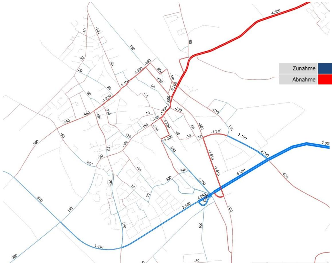
Abb. 2.3.1.3-12 Verkehrsmodell Istzustand 2030 mit OW1 (Differenz zur Nullprognose 2030 ohne OW1) (DTVw-Werte in Kfz/24h an einem normalen Werktag (Mo-Fr))
