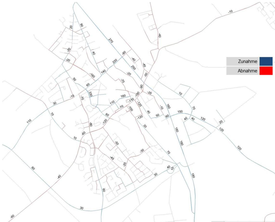
Abb. 2.3.1.3-9 Differenzdarstellung Nullprognose 2030 ohne OW1 im Vergleich zum Istzustand 2019 (DTVw-Werte in Kfz/24h an einem normalen Werktag (Mo-Fr))
